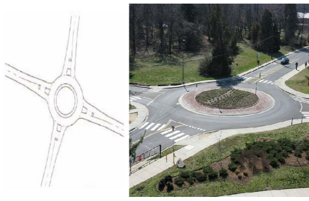
รูปที่ 5 ตัวอย่าง Compact One Lane Roundabouts
