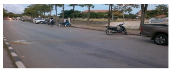
รูปที่ 7 เนินชะลอความเร็วหน้าหอพักกันทรวิชัยมหาวิทยาลัย มหาสารคาม ขนาด กว้าง 1.5 เมตร สูง 0.075 เมตร
