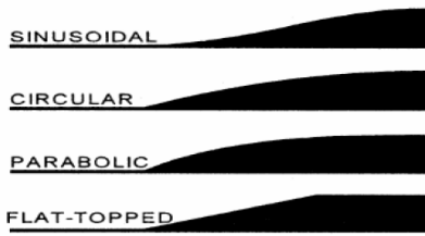
รูปที่ 1 ลักษณะหน้าตัดทางลาดของลูกเนินชะลอความเร็วแบบต่าง ๆ ที่มา : Ewing, 1999
