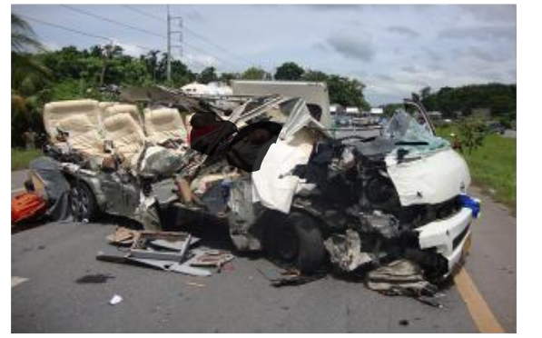
รูปที่ 10 โครงสร้างรถด้านข้าง และโครงหลังคาหลุดออกจากตัวถังรถ กรณีรถตู้ชนรถบรรทุก 6 ล้อ บริเวณทางเบี่ยง จ.สุราษฎร์ธานี
