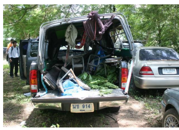
รูปที่ 11 น็อตยึดโครงหลังคาและแก้อี้อหลุดออกจากตัวถังรถ กรณีรถกระบะชนรถบรรทุก 10 ล้อ บริเวณ 4 แยก บ้านท่าช้าง จ.สงขลา
