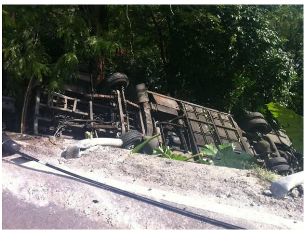
รูปที่ 8 ราวกันอันตรายไม่สามารถป้องกันรถหัวร ทำให้เสียหลักตกข้างทาง บริเวณ โค้งสะตอ ต.กะรน จ.ภูเก็ต
