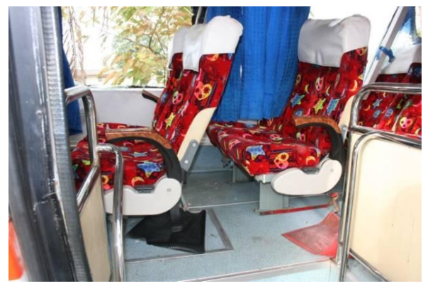
รูปที่ 9 ไม่มีเข็มขัดนิรภัยติดตั้งภายในรถโดยสาร กรณีรถมินิบัสสายหาดใหญ่ – ภูเก็ต เสียหลัก จ.สงขลา
